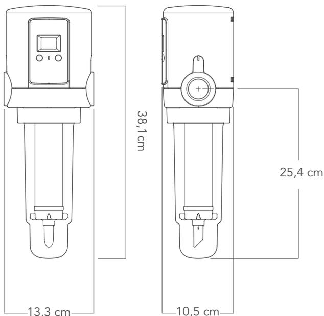
Questo sistema filtra l'acqua proveniente dalla rete municipale impedendo l'ingresso dei sedimenti, proteggendo gli elettrodomestici e l'impianto idraulico.
